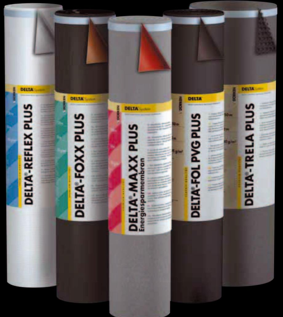
Moderne tehnologije gradnje kosi krovova sa paropropusnim hidroizolacionim krovnim folijama omogućavaju gradnju krovova bez podaščavanja i bez donje ventilacione zone, pošto su najnovije generacije folija samonošive i toliko paropropusne da se razmena vlagom zasićenog vazduha vrši direktno kroz foliju. Obzirom da nema donje ventilacione zone, povećava se funkcionalnost termoizolacije i dobija se par santimetara za njeno povećanje.
